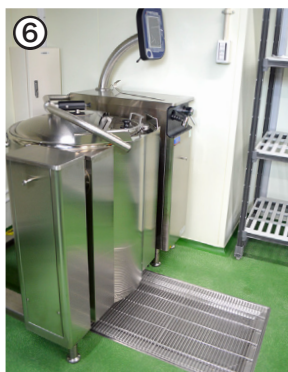
④調理用長靴を洗浄するシンク ⑤キッチンで作られた料理を保管スペースに移す際に異物混入を防ぐ2重開閉扉 ⑥大鍋からスムーズに排水できる排水口 ⑦ホコリの侵入を防ぎ掃除がしやすいHACCP（※）対応の照明 ※ HACCP（ハサップ）とは「Hazard（危害）」「Analysis（分析）」「Critical（重要）」「Control（管理）」「Point（点）」という言葉の略語で、食品を製造する際に安全を確保するための管理手法のことを言います。
